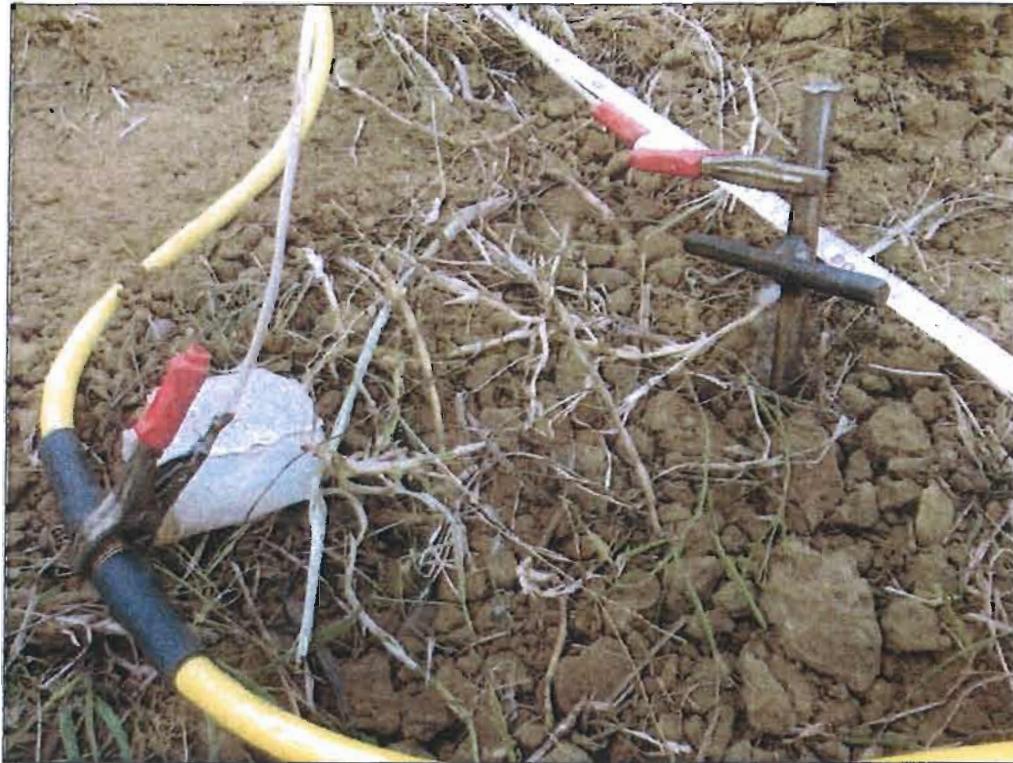
Foto 13: Postazione ed allineamento della Tomografia Elettrica T.E.1 - particolare di un elettrodo utilizzato nella Tomografia Elettrica -
