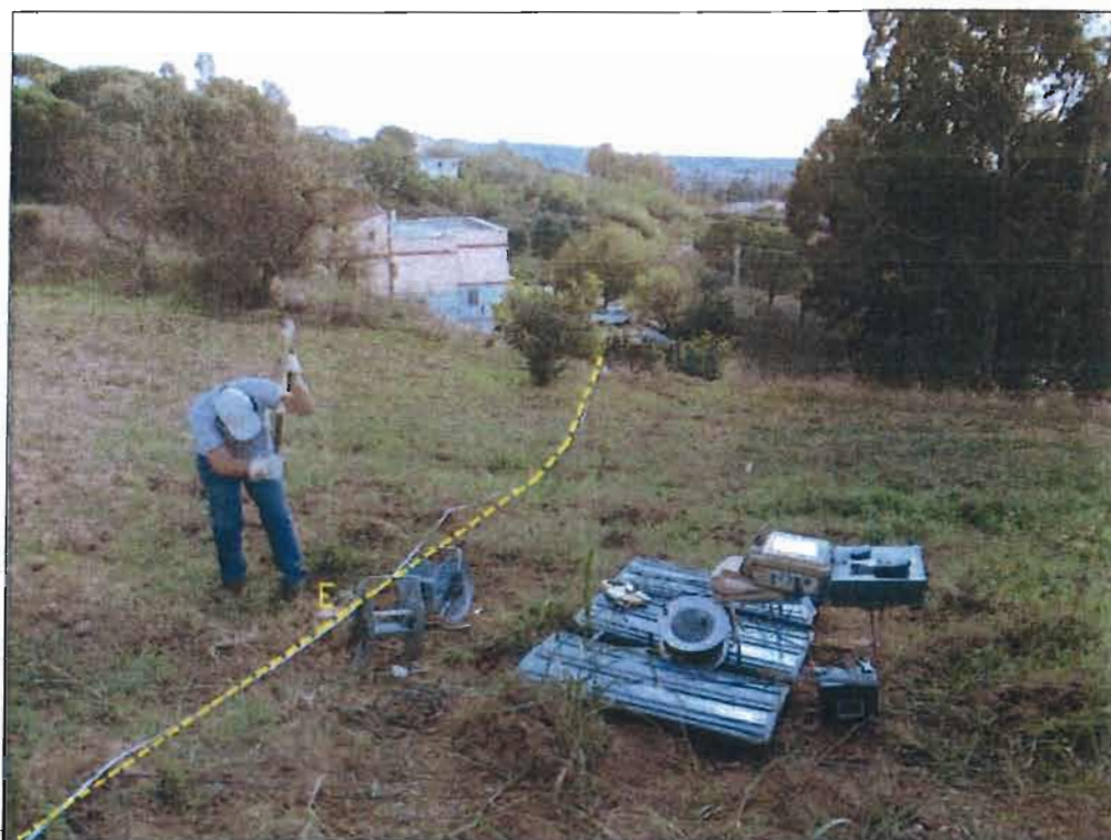
Foto 5: Postazione ed allineamento della Base Sismica B.S.1 - particolare dell'esecuzione di una battuta in onde P nel punto di scoppio E -
