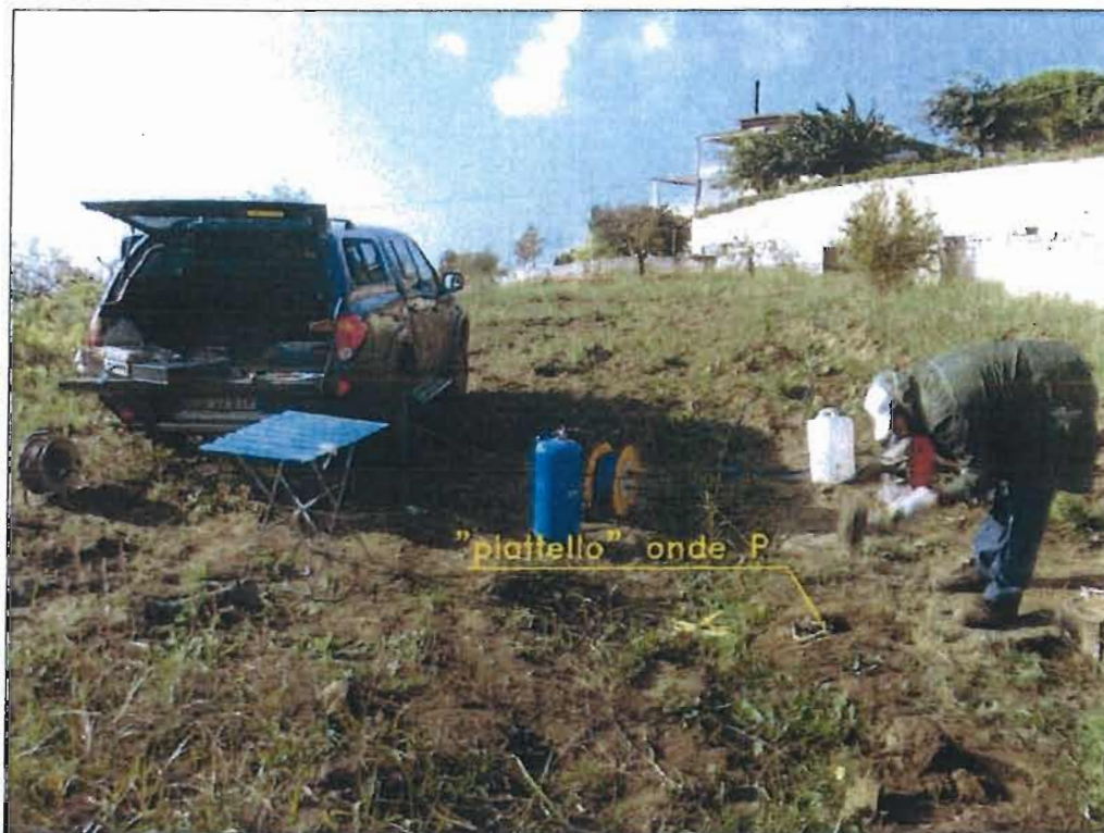
Foto 9: Postazione della prova "Down-Hole" D.H.1 (perforo attrezzato S.1) - particolare di una battuta in onde P -
