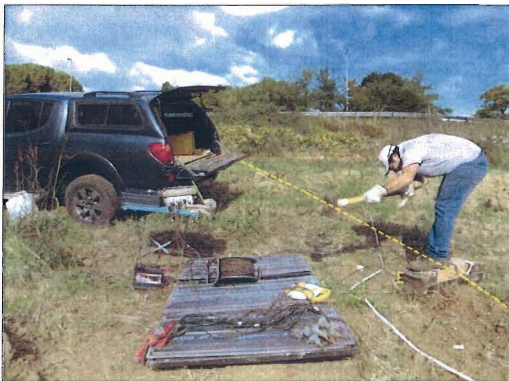
Foto 6: Postazione ed allineamento della Base Sismica B.S.1 - particolare dell'esecuzione di una battuta in onde S nel punto di scoppio E -
