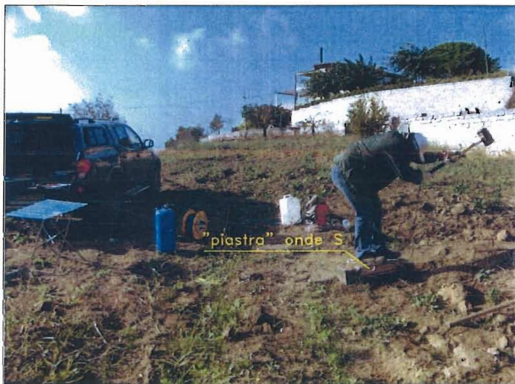
Foto 10: Postazione della prova "Down-Hole" D.H.1 (perforo attrezzato S.1) - particolare di una battuta in onde S -
