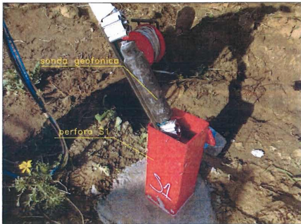
Foto 8: Postazione della prova "Down-Hole" D.H.1 (perforo attrezzato S.1) - particolare della sonda geofonica (a 5 geofoni) -
