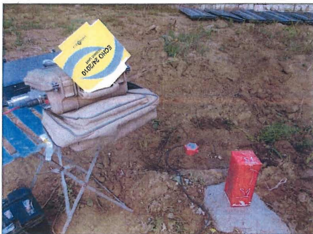
Foto 12: Particolare della stazione di acquisizione dati della Prova HVSR.2 (nei pressi di S.1)
