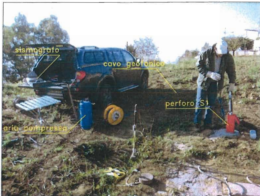
Foto 7: Postazione della prova "Down-Hole" D.H.1 (perforo attrezzato S.1) - strumentazioni e dispositivi utilizzati -
