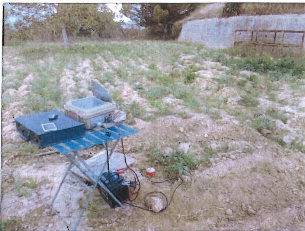
Foto 11: Particolare della stazione di acquisizione dati della Prova HVSR.1 (nei pressi di S.3)
