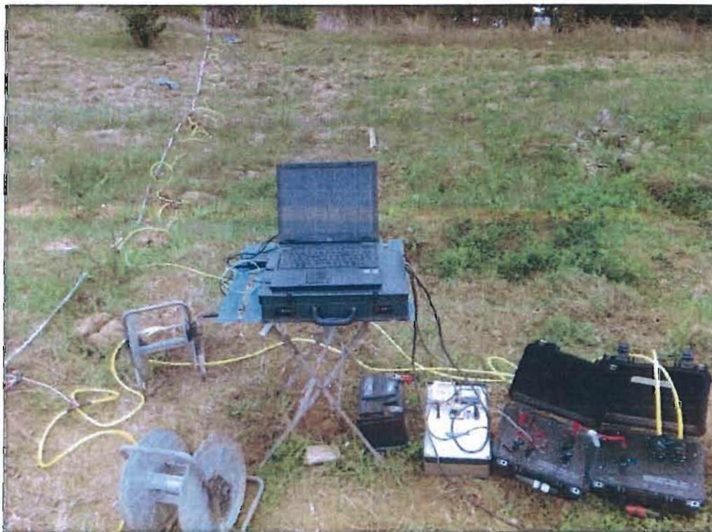
Foto 14: Postazione ed allineamento della Tomografia Elettrica T.E.1 - particolare della stazione di acquisizione dei dati geoelettrici -
